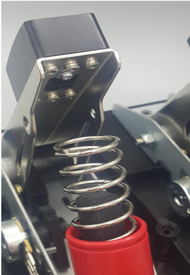
*Abb 3.2.2: Original-Feder mit Gummi Quader.*
